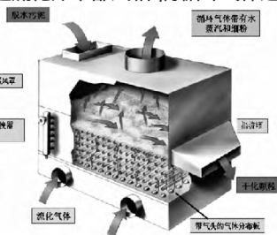
图7 流化床原理示意图
